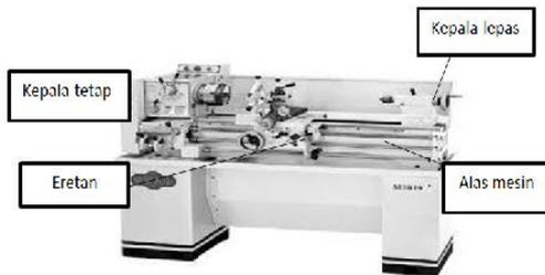
Gambar 1 Bagian-Bagian Utama Mesin Bubut
